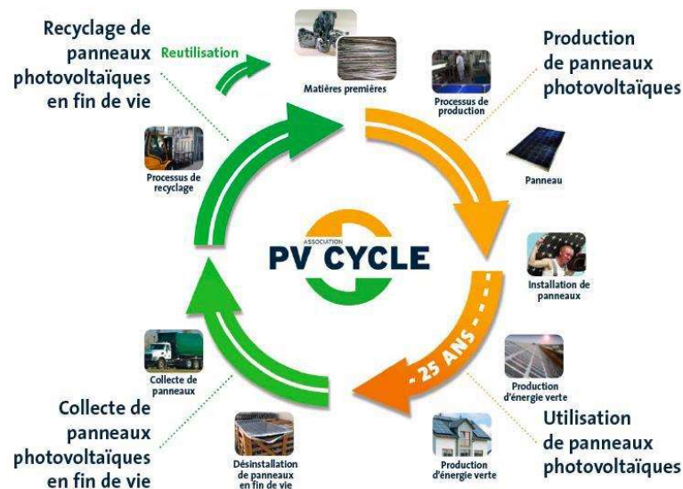
Figure 6 : Schéma de recyclage des panneaux par PV CYCLE
