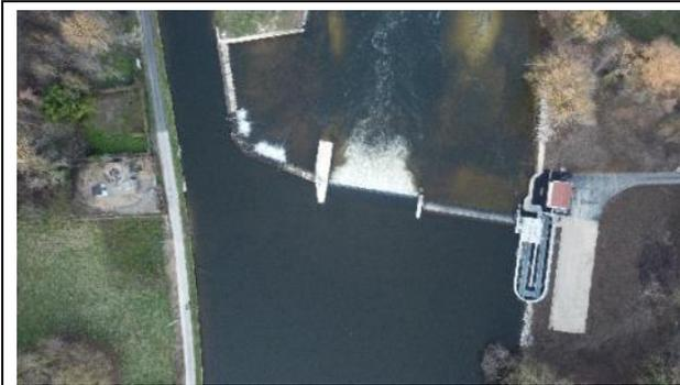
Un seuil de 120 m de long, rénové en 2019 équipé d'un barrage gonflable à l'eau. La chute au droit du seuil a été mesurée à 1.3m
