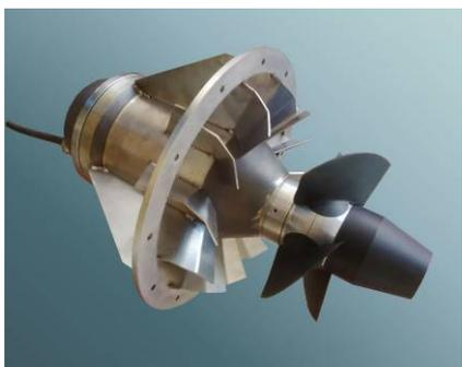
Basées sur la technologie des turbines de type Kaplan les turbines Turbiwatt sont de conception assez simple et la maintenance est réduite. Adaptées aux basses chutes (entre 1.20 m et 8 m selon les modèles) et à des débits compris entre 50 et 4 000 L/s pour des puissances nominales allant de 1 kW à 130 kW.
