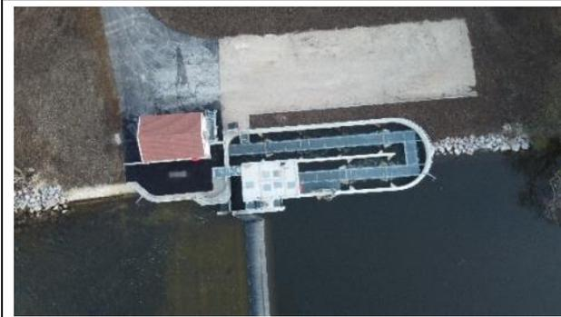
Une passe à poisson à bassins successifs réalisée en 2019 situé en rive droite de l'Yonne
